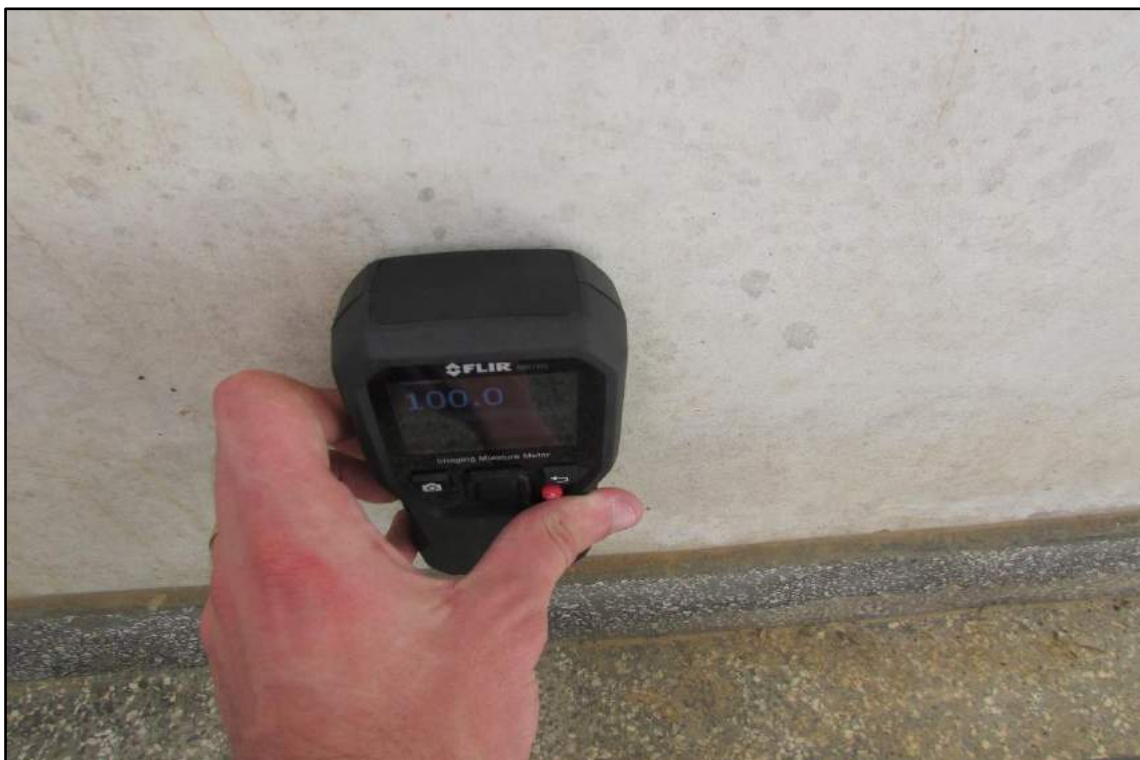
Imagem 159 - Teste de umidade no revestimento interno da sala de aula 2. Visor indica teor de umidade superficial 100 em uma escala de 0 a 100.
